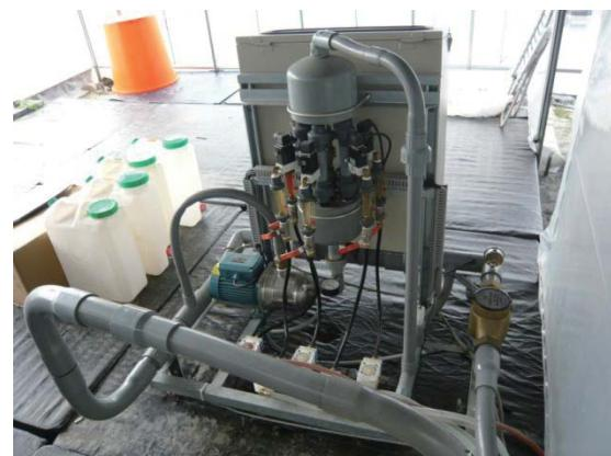
3<sup>rd</sup> G 中改型自動肥灌系統主機之養液注入管路
