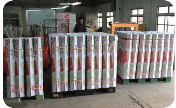
圖 8. 4 個包裝箱為 1 組並束帶機固定
