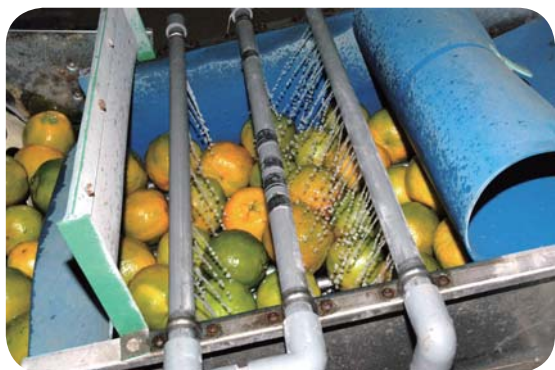
圖 11. 沖淋防腐藥劑作業
