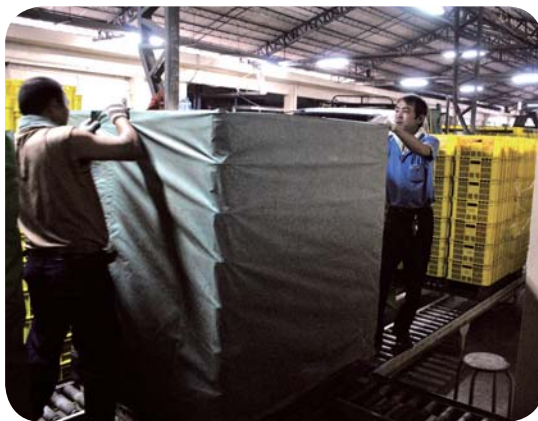
圖 6. 堆疊後以塑膠帆布將四邊封住，推入蒸熱室檢疫
