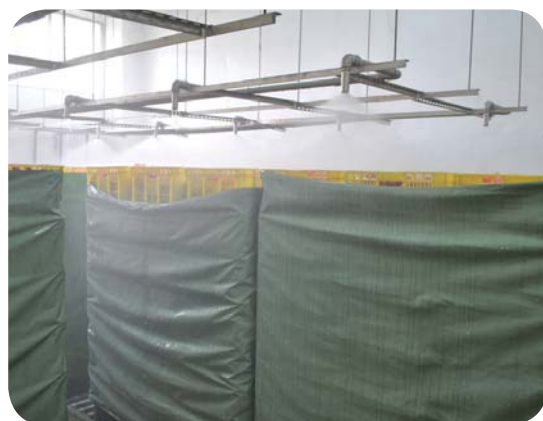
圖 7. 蒸熱完成後立即以冷水噴灑降溫
