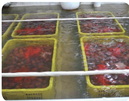
圖 8. 置入 1°C 之冰水池，以輸送帶運送降溫
