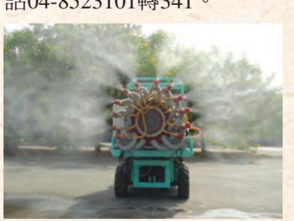
▲九十五年研製之中型電動自走鼓風噴霧情形
