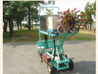
▲九十五年研製之中型電動自走鼓風噴霧機結構
