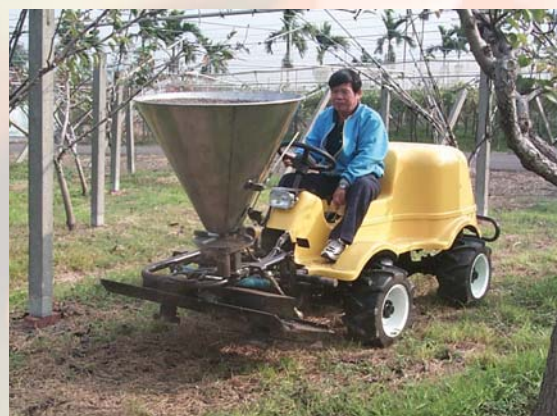
▲承載施肥裝置進行追肥撒施
