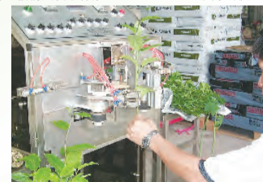
▲圖八：百香果種苗嫁接機作業情形
