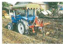
●圖6. 塊根挖掘機作業挖取塊根
