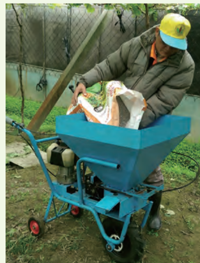
▲機械操作前，先將肥料倒入肥料斗，並調整撒施方向
