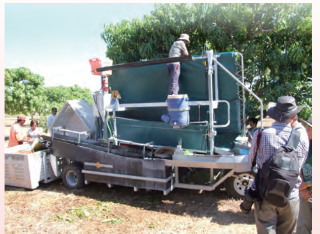
▲澳洲芒果經光波檢測合格後以綠熟果採收，經清洗、風乾與分級後裝入有襯底的紙盒中，可減少果實晃動與提高作業效率
