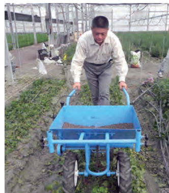
◀手推式施肥機，幫助農友均勻施用肥料，並提高3倍工作效率
