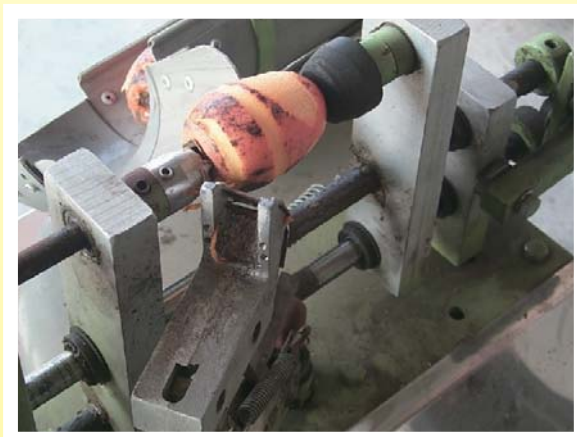
筆柿以牛心柿削皮機作業情形
