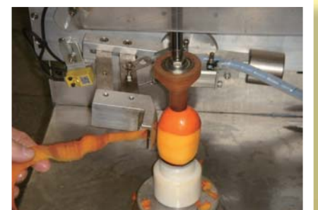
第二段削皮作業（筆柿削皮機左側）
