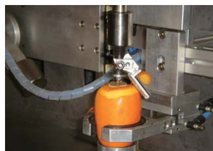
第一段削皮作業（筆柿削皮機右側）
