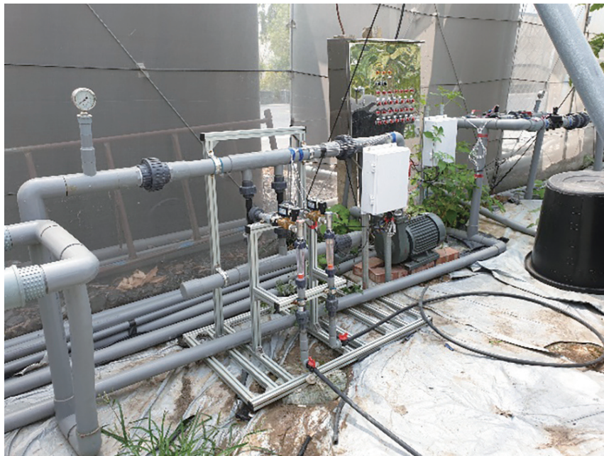
圖三、智慧肥灌系統在木瓜果園設置情形。
