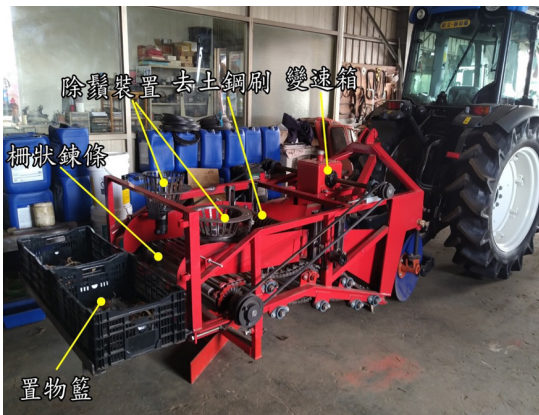
▲ 母芋收穫機之柵狀挖掘鏈條與鋼刷結構雛形機設計與配置說明
