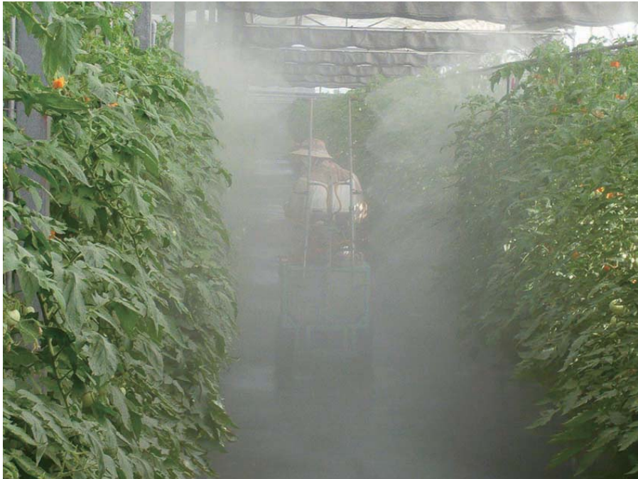
圖五、電動三輪自走式噴霧機雙側噴霧亦可單側噴霧
