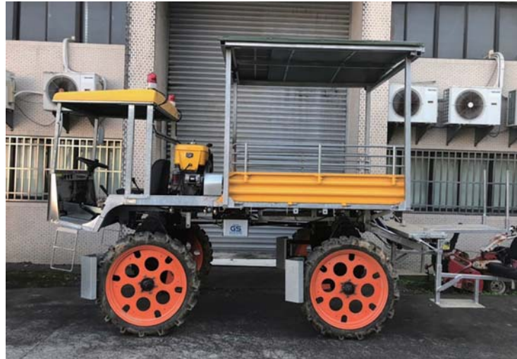
圖一、鳳梨採收原型機（乘坐式鳳梨採收平台，新型第 M579445 號專利）
