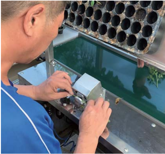
圖七、人員操作切苗裝置斜切苗株作業情況
