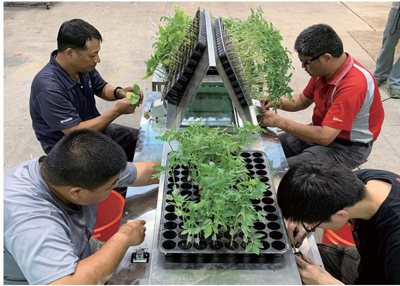
圖六、輸送帶式嫁接輔助機具作業情形
