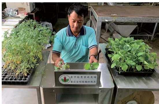
圖二、番茄苗嫁接輔助機具作業情形
