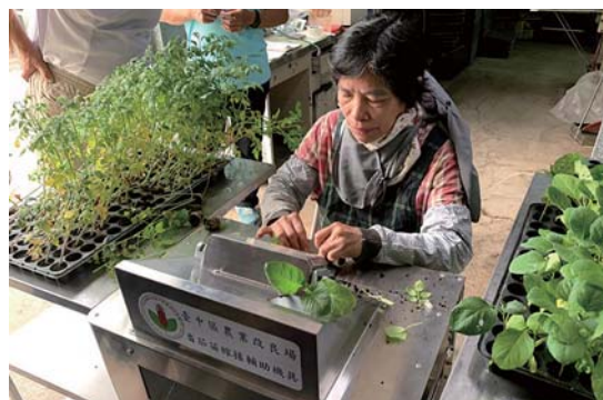
圖三、番茄苗嫁接輔助機具作業情形
