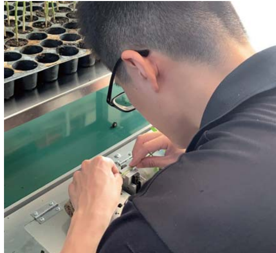
圖八、人員操作嫁接裝置進行苗株接合作業情況
