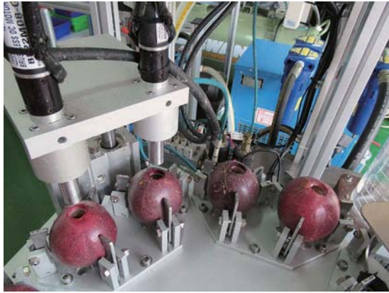
圖五、利用鑽頭洗孔刀進行果殼的表皮開孔之情形
