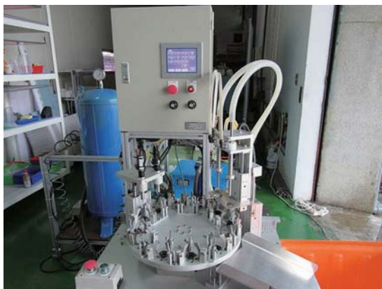
圖三、百香果取漿機械主要各部結構與取漿作業程序所對應的機構位置
