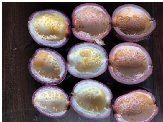
圖九、經過正負氣旋交互作用抽吸 2 次的果漿殘留情形
