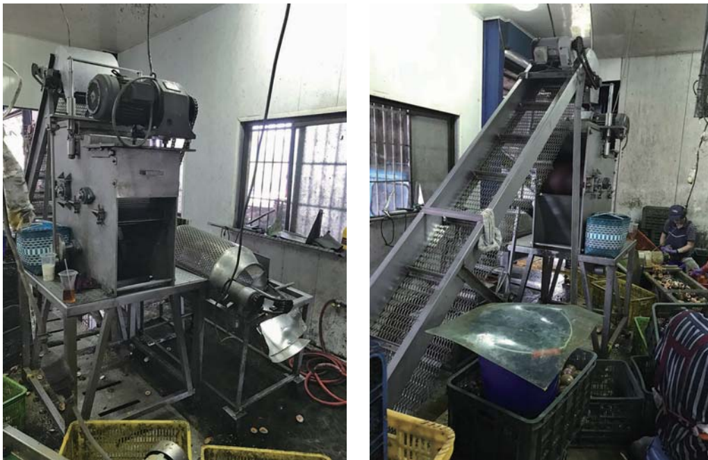
圖一、傳統式的壓榨式取漿機械，因會造成果皮藥劑與果漿的污染而大多廢棄不用
