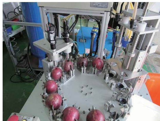
圖四、百香果取漿機械之果料轉盤機構與其對應的各部作業作用位置圖
