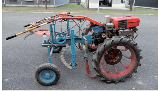
圖六、自走式洋蔥挖掘機械
