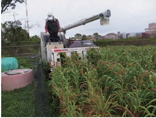
圖六、小米使用水稻聯合收穫機進行收穫試驗
