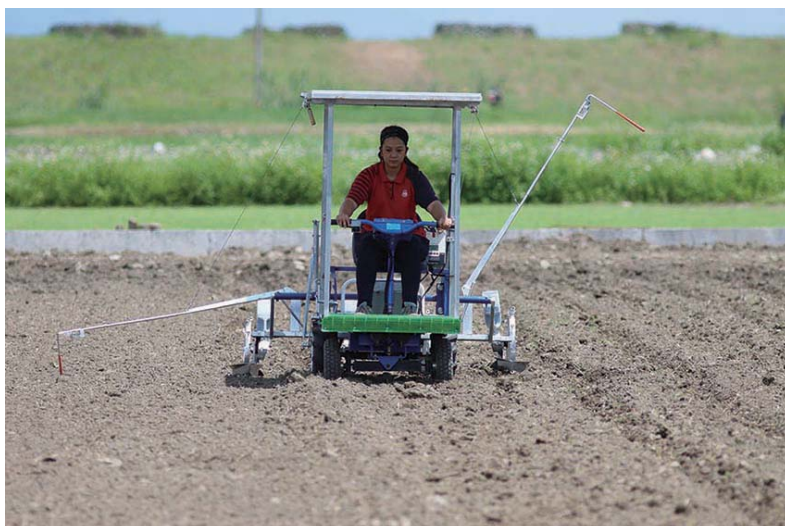
圖三、太陽能雜糧播種機構造簡單輕巧，女性農友也可輕鬆操作。
