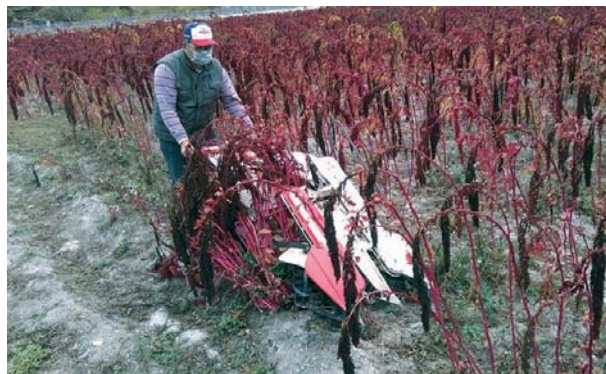
圖九、改良二行式小型割稻網綁機進行臺灣藜收割情形
