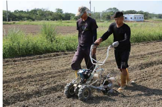
圖二、自走式小粒徑種子播種機田間播種情形
