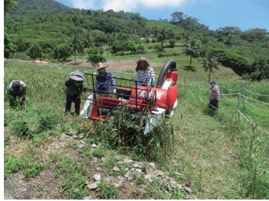
圖七、全餵入收穫機於坡地進行小米收穫情形
