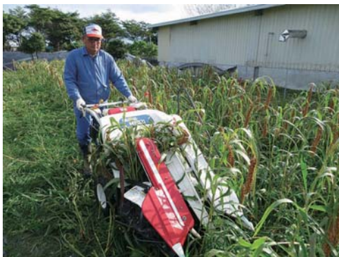
圖八、改良二行式小型割稻網綁機進行小米收割情形
