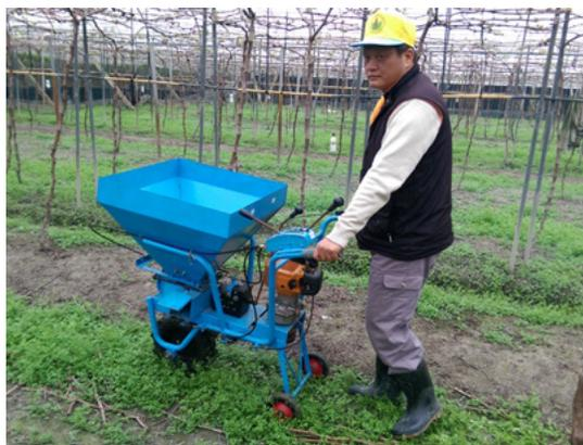
手扶自走式施肥機結構操作情形
