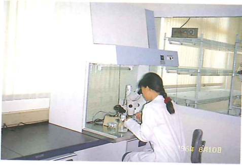
開放式無菌操作台，內裝HEPA高效能過濾網以維持無菌狀態。
