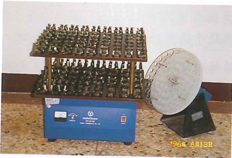
搖床(左)與轉床(右)，常用於液體培養或培植體初代培養，有利於誘發大量不定芽。
