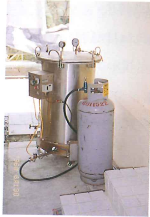
高壓殺菌釜，裝有定溫控制器，以維持殺菌條件為 121\text{ }^{\circ}\text{C} 及壓力 1.05\text{kg/cm}^2 ，15~20分鐘。
