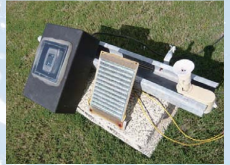
▲三種下雨感測器（左：電子式；中：電阻式；右：重量式）
