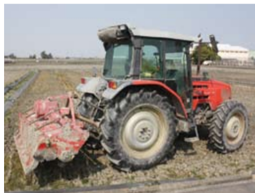
▲曳引機頭地轉彎時，犁具舉升角度避免過大而折損傳動組件
