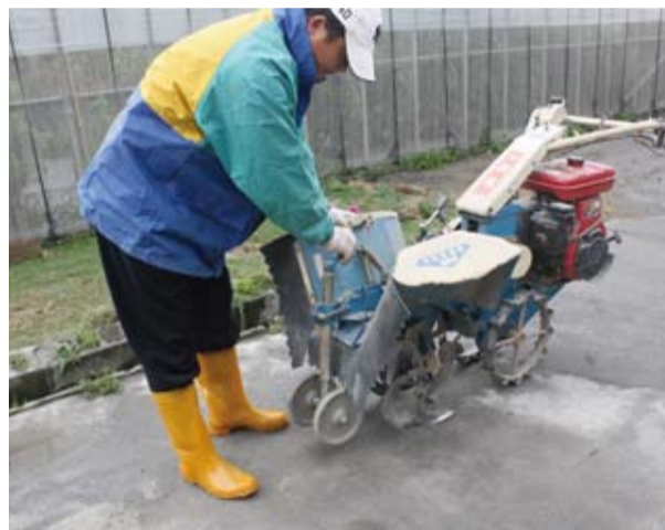
▲中耕管理機築畦作業前進行支撐尾輪及左右蓋板等調整
