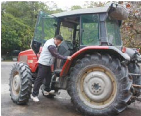
▲上下曳引機駕駛艙應面向機械與踏穩腳步
