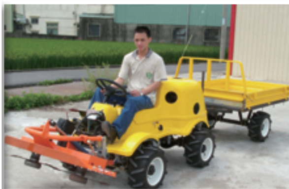
割草機後方可掛載雙輪拖車，進行相關資材搬運作業
