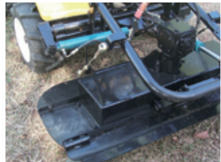
割草機構之舉升與橫移功能皆採油壓缸作動來達成
