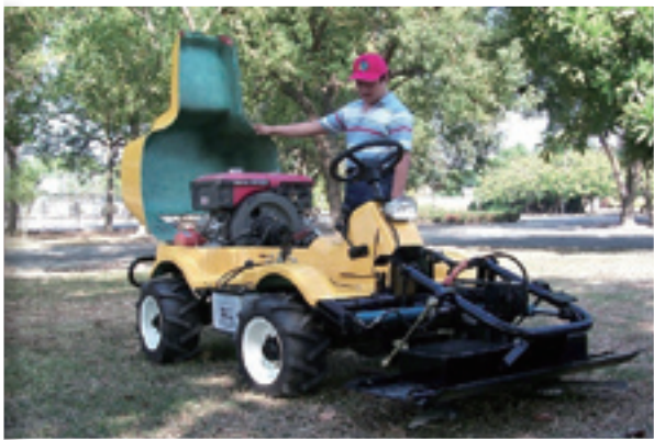
本機採後置引擎設計及機身以強化玻璃纖維開模製造
