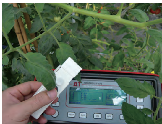
以氣孔導度儀測量番茄葉片氣孔阻力
