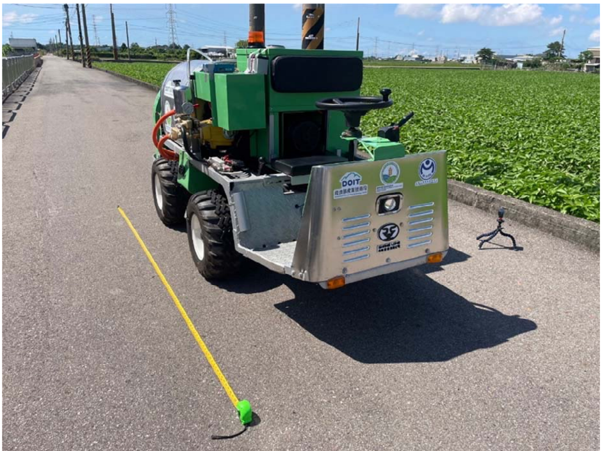
圖一、電動農機於平面道路進行連續行駛續航力測定。
