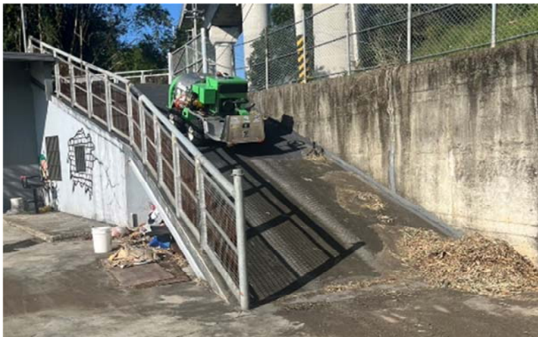
圖五、電動農機於坡地道路進行安全停駐測定。
