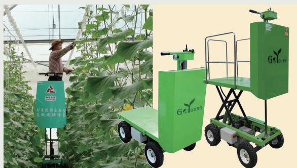
電動自走式升降作業機，適用於設施棚架式高莖作物之栽培管理工作
