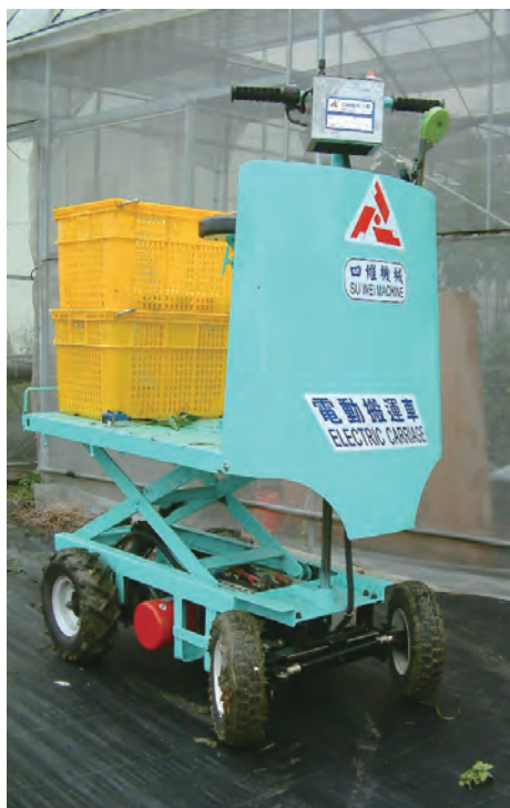
升降作業機採油壓舉升作業
