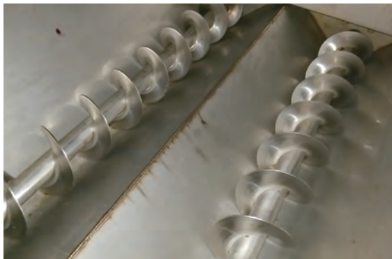
肥料箱底部之雙螺旋輸送軸
