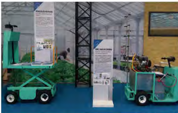
溫室果菜作物輔助管理之電動升降作業機與三輪式噴霧機
