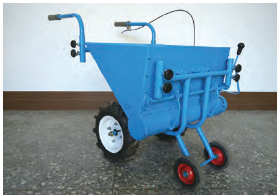
試驗研發之手推式施肥機雛型
