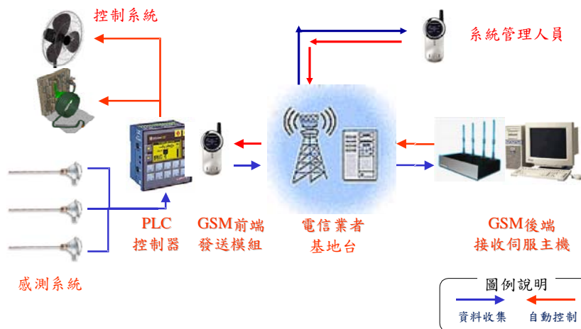
圖一、溫室 GSM 遠距無線監控系統架構圖。
