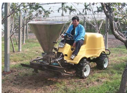
承載施肥裝置進行追肥撒施
