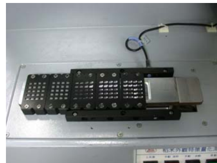
圖二、半自動型米粒進料與定位機構。
