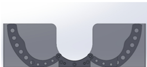
圖四、包覆夾爪作動前。 Fig. 4. Before wrapping grippers action.
