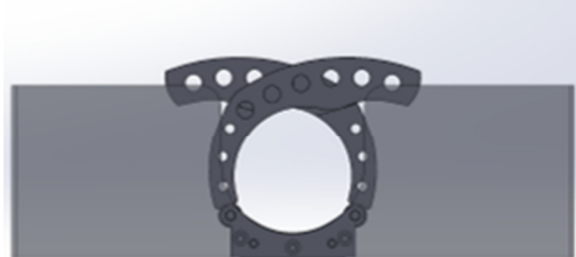
圖五、包覆夾爪作動後。 Fig. 5. After wrapping grippers action.
