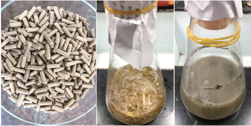
菌株 TCPiA 與蝦蟹殼粉混合造粒 (左圖)，並接種於羽毛培養基 (中圖) 經培養可分解羽毛 (右圖)
