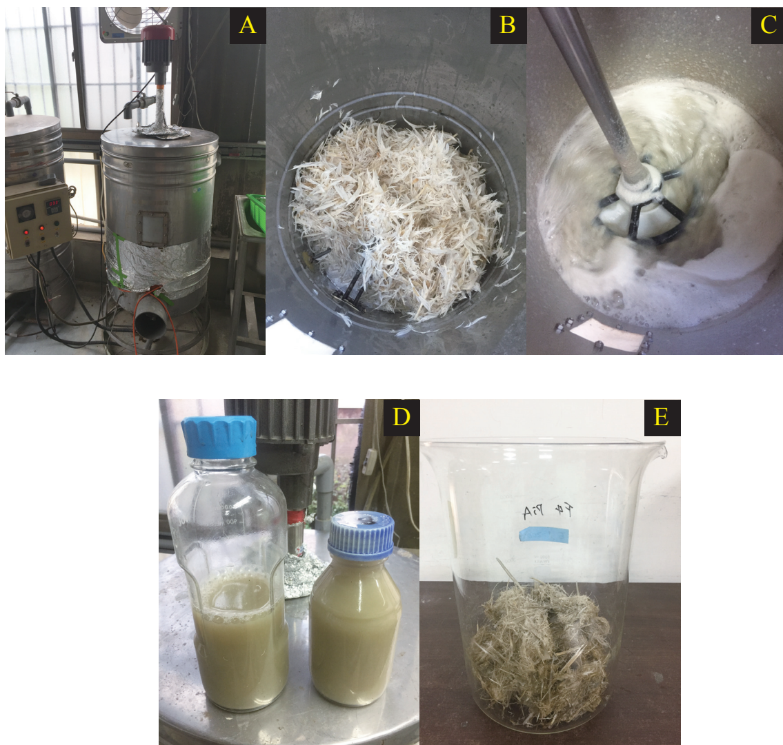
A-C 羽毛水解過程、D 羽毛水解成品、E 殘留羽毛量
