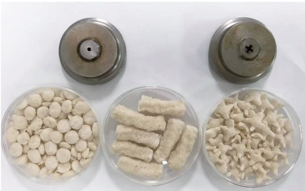
運用米果機膜孔形狀和切刀速度之調整可生產多元化膨發產品
