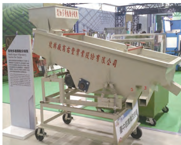
穀物多層振動分級機可依不同粒徑尺寸更換篩網及調整傾斜角度
