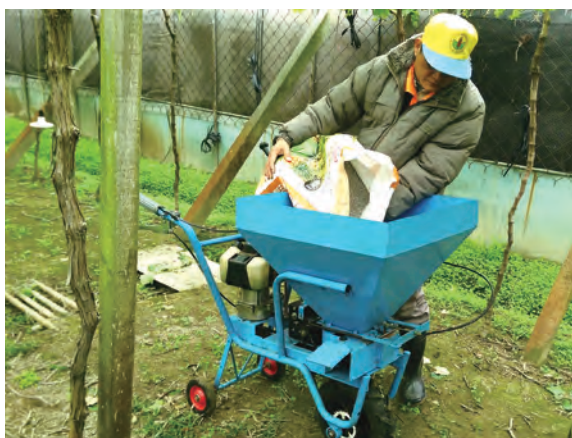
施肥機作業前將肥料倒入肥料斗與調整撒施方向
