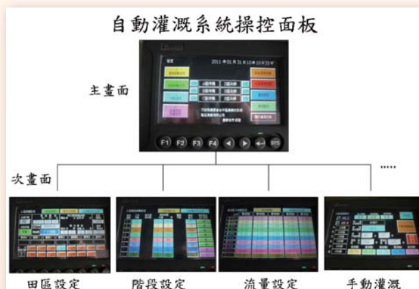
圖二、自動肥灌系統具有多樣的參數設定功能
